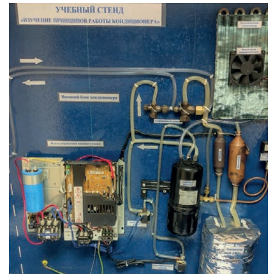
Учебный стенд для изучения принципов работы кондиционера
