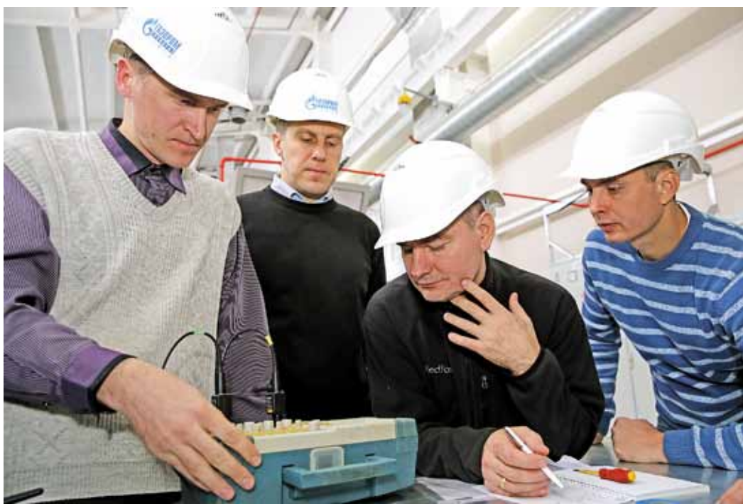
С помощью калибратора изучается точность и скорость работы клапана
